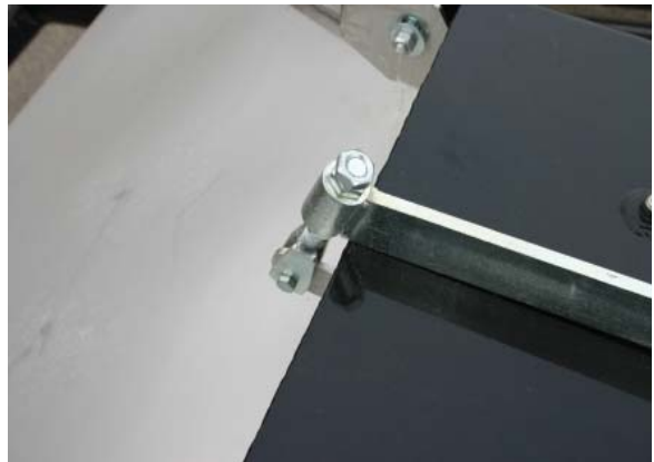
Jam nuts on hold-down bar
