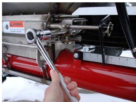
Регулировка отсечной заслонки дозатора
