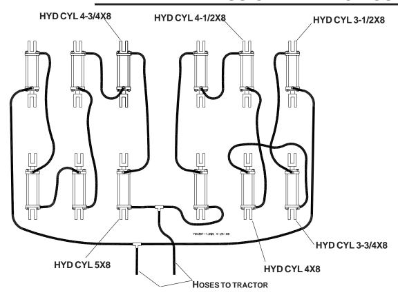
REFER TO PAGE 43 FOR CYLINDER LOCATIONS ON THE MAIN UNIT, NOTE ORIENTATION OF FRONT CYLINDERS ON THE LEFT SIDE OF THE UNIT. ILLUSTRATION SHOWS 50FT & 60FT UNIT, 40FT UNIT DOES NOT USE THE
